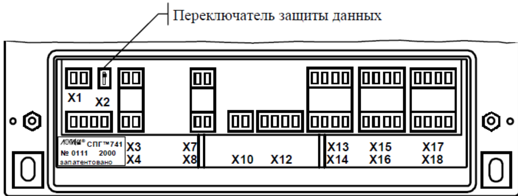
Рис. 2-3 Общий вид монтажной части прибора СПГ741
