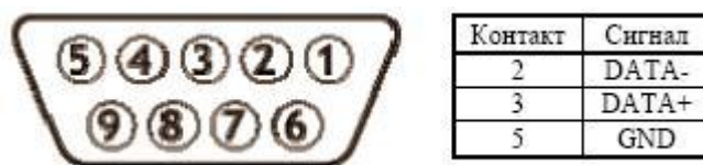
Рис. 3-3 Разъем интерфейса RS485 МБУ 9DBM.
